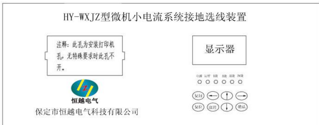
(图四) HY—WXJZ 型微机小电流系统接地选线装置面板布置图
